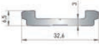
5266 CEPHE BAĞLANTI (YATAY) 0.330 kg/mt
