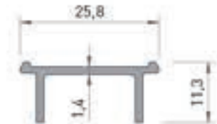
2484 HAREKETLİ GÜNEŞ KIRICI MAFSAL BAĞLANTI PROFİLİ 0.175 kg/mt
