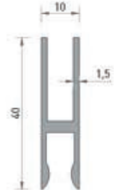
2155 SÜRME CAM "H" PROFİL 0.380 kg/mt
