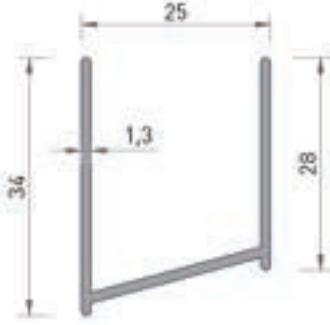
2385 AÇILI DUVAR DİKME 0.300 kg/mt
