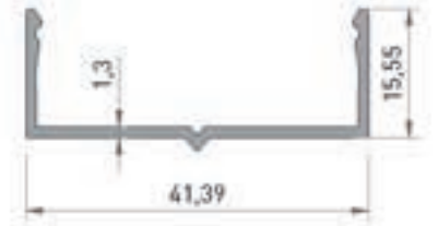
4585 HAREKETLİ GÜNEŞ KIRICI DÜŞEY ÇİTA 0.250 kg/mt
