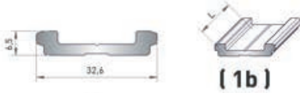
5266 CEPHE BAĞLANTI (YATAY) 0.330 kg/mt
