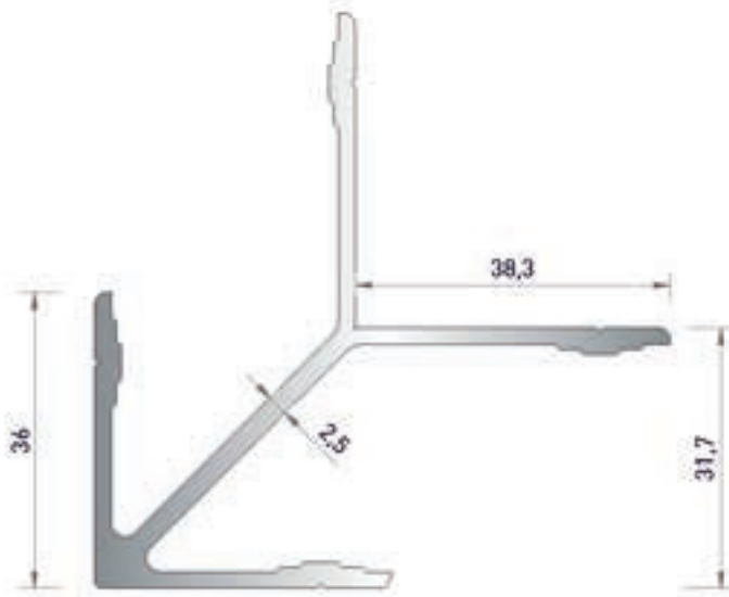
2151-B GENİŞ ÇAVUŞ KÖŞE BAĞLANTI 1.180 kg/m
