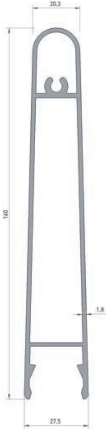
2683 GÜNEŞ KIRICI YAPRAK PROFİL 1.965 kg/mt Jx : 174.25 cm 4 Jy : 7.52 cm 4
