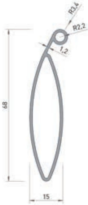
1953 HAREKETLİ GÜNEŞ KIRICI MAFSAL 0.475 kg/mt Jx : 7.10 cm 4 Jy : 0.45 cm 4
