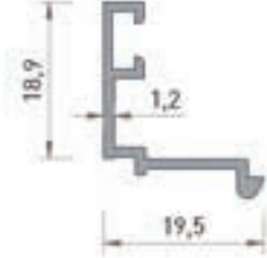
2027 KALIN CAM ÇİTASI TIRNAK ADAPTÖR 0.170 kg/mt
