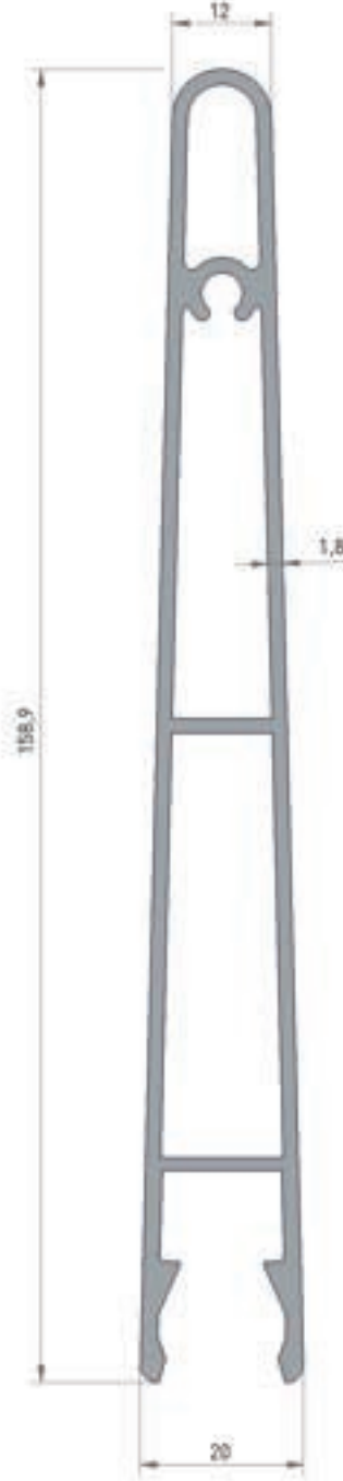
5498 GÜNEŞ KIRICI YAPRAK PROFİL 1.880 kg/mt Jx : 3.13 cm 4 Jy : 156.41 cm 4
